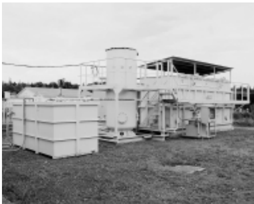
汚泥減量化試験装置
