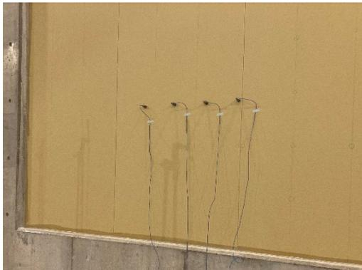
写真-6 加速度ピックアップ設置状況
