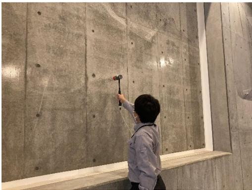
写真-5 インパクトハンマによる加振状況
