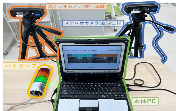
図-1 切羽監視システムの全体像
