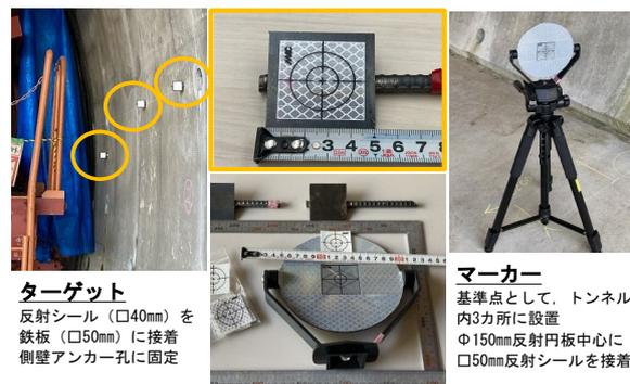
図-2 マーカおよびターゲットの概要
