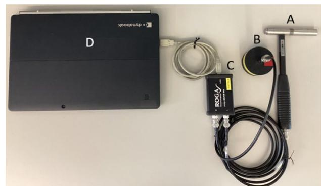
写真-1 マルチ打音システム (A: インパクトハンマー, B: フード付きマイクロフォン, C: A/Dコンバータ, D: 測定PC)
