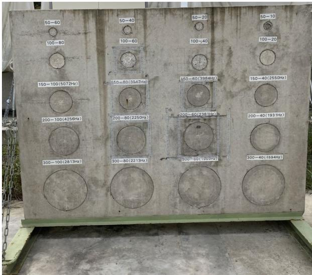
写真-2 欠陥模擬試験体
