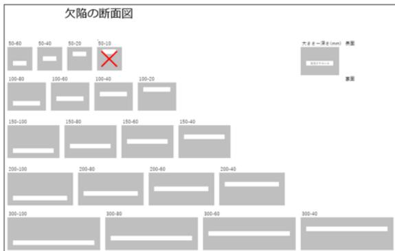
図-1 欠陥種類 直径(mm)-深さ(mm)
